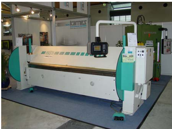
Bild 1: Schwenkbiegemaschine (Vorderseite) mit durchgehender Biegeschiene an Oberwange bzw. Biegewange
