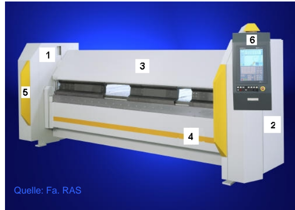
Bild 4: Schwenkbiegemaschine (Vorderseite) mit segmentierter Biegeschiene an der Oberwange und an der Biegewange
