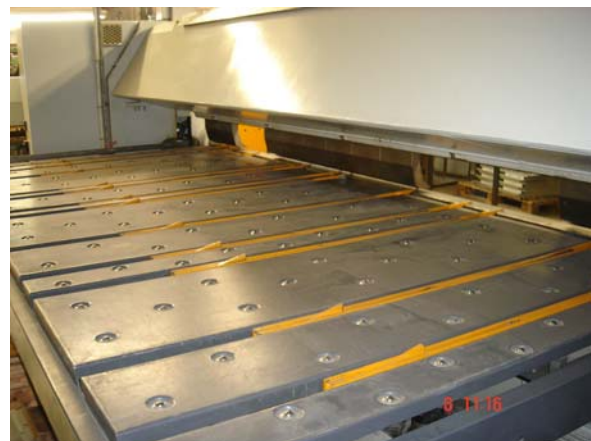
Bild 5: Auflagetisch an der Rückseite einer Schwenkbiegemaschine mit segmentierter Oberwange
