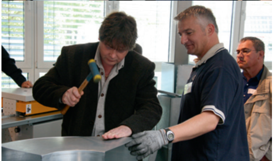
Da staunen selbst Dachprofis wie Beat Scherrer (li. oben) vom gleichnamigen Fachbetrieb in Zürich: Michael Klein führt die Herstellung eines Kanalbogens vor. Dabei bördelt er gebogene Seitenteile oder profiliert einen Schnappfalz. Anschließend werden Außen- und Innenzargen über die segmentierte Rundbogenmaschine Ventirounder spannungsarm in Form gebracht. Die Überprüfung der Passgenauigkeit übernehmen die qualitätsbewussten Gäste
