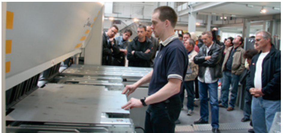
Stolz verkündet Thomas Berger: „UpDownBend – das ist 3,2-m-Schwenkbiegen nach oben und unten bei Stahl bis zu 4 mm.“ Ab Sommer 2009 wird erstmals wechselseitiges RAS-Schwenkbiegen bis zu 4 m Länge möglich sein. Dann für Stahlbauteile bis zu 3 mm und bei beiden Maschinenvarianten mit 200 mm hohen Geißfußwerkzeugen. Aus Sicherheitsgründen erfolgt die Bedienung von der Anschlagseite aus. Der Vorderbereich der Maschine muss nur zum Wechseln der Werkzeuge betreten werden. Ein völlig neuartiges Teleskop-Anschlagssystem passt sich in seiner Größe automatisch an die aktuelle Biegesituation an. So verkleinert sich das Anschlagssystem beispielsweise bei kleinen Biegeteilen
