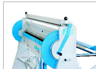
Stahlwalzen zum Rinnen runden von diversen Durchmessern.
