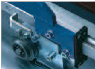
Rollenschiere zum Quertrennen von Hand vor dem Profilieren.
