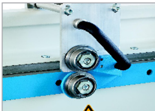
Rollenscherer für Stahl-Blechdicken bis 0.8 mm.
