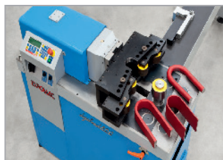
4-Punkt-Biegewerkzeug für Rund-Flach- oder 4-Kt.-Material und dickwandige Rohre bis 180°. Max. 100 x 20 mm oder Ø 50 mm.
