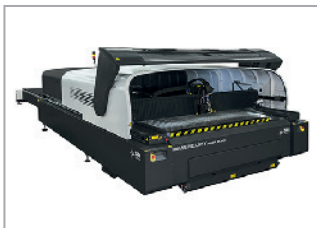
Palettenwechsler für kurze Rüstzeiten mit 2 Schneidtischen.
