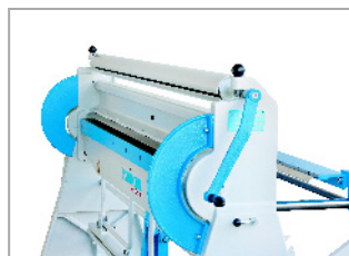
Stahlwalzen zum Rinnen runden von diversen Durchmessern.
