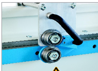
Rollenscherer für Stahl-Blechdicken bis 0.8 mm.
