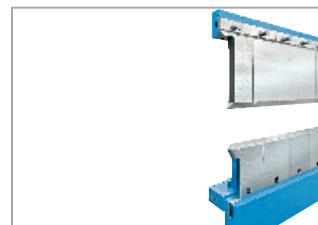
Le zinc et l'alu peuvent être cintrés avec ménagement grâce aux arrondis plus prononcés des inserts de tablier supérieur de 2 ou 3 mm de rayon.
