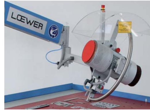
Schwenkbare Schleifkopf 180 Grad für schnelle Verfügbarkeit von Entgrat- und Verrundungswerkzeug
