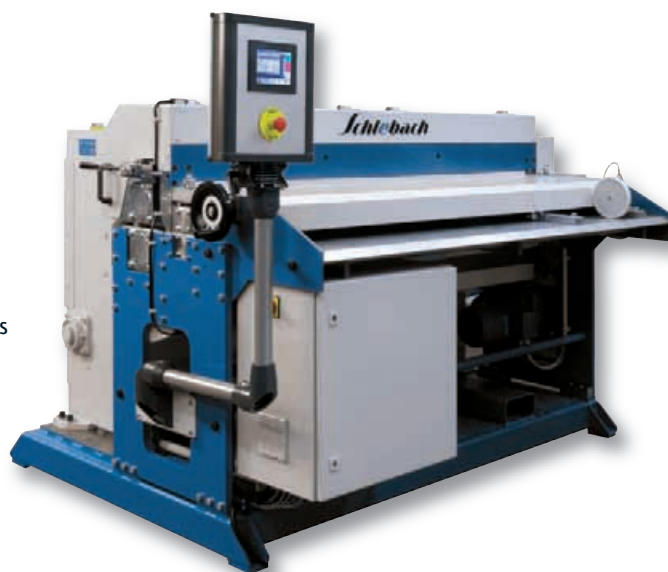
Refendeuse et coupe à longueur à commande SPS écran tactile
