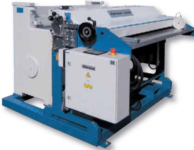
Refendeuse équipée d'une cisaille guillotine et d'une commande numérique
