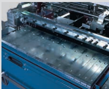
Serrage des segments dans la partie supérieure et le tablier de pliage
