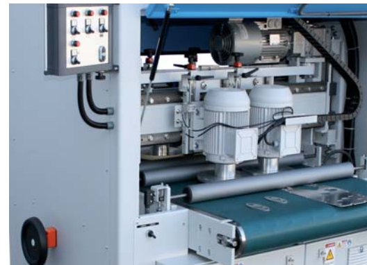
Blechkickeneinstellung über Handrad, optional motorisch
