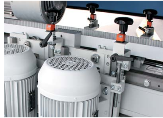
Einzeln verstellbare Discs zur einfachen Kompensation unterschiedlicher Werkzeugdicken
