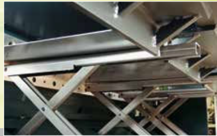
Blechhochhalteanlage mit "Return-To-Sender"-Funktion
