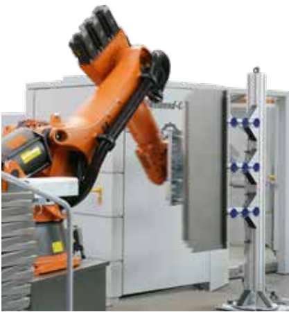
Wendestation für Fertigteile
