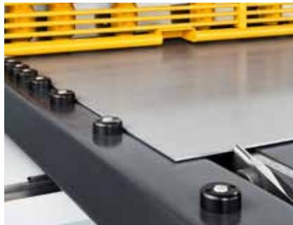
Kippanschläge (wahlweise mit Präzisionsskala) erlauben ein exaktes Positionieren der Bleche.
