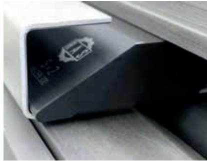
Werkzeuge mit Radius für das Biegen von Aluminium.
