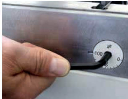
Einstellung des CrownTools zum Bombieren des Biegewangen-Werkzeugs (speziell beim Stepbiegen von Radien).
