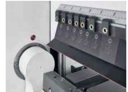
Ein Laser ermittelt automatisch die exakte Werkzeughöhe.
