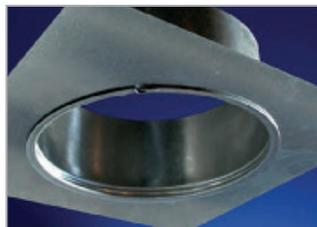
Schnell und einfach mit den Schraubsickenwalzen erstellt.
