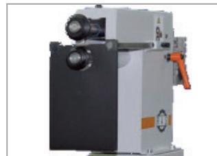
Geteilter Anschlag mit gehärteter grosser Anschlagplatte (240 x 160 mm).
