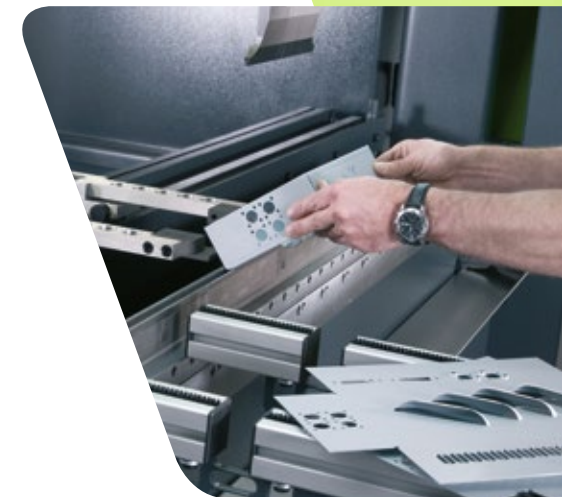
Biegen des Testproduktes
