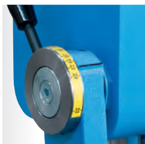
Druck der Oberwange per Hebel justierbar
