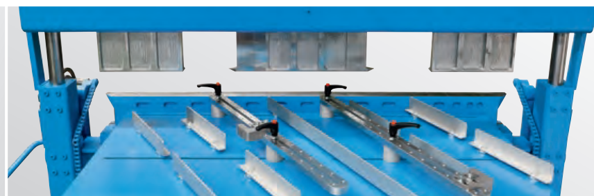
Magnetische Führungsschienen, alle Biegewinkel frei justierbar
