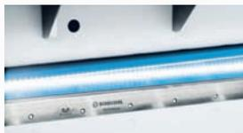
Die Werkstattbeleuchtung streut ein diffuses Licht und der Messerbalken wirft dunkle Schatten. Beides erschwert es dem Bediener, die Schnittposition gut zu erkennen.
