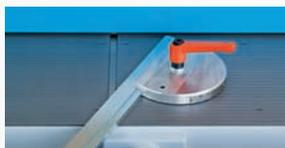
Passgenaue Gehrungsschnitte erzielt der Spengler mit einem speziellen Winkelanschlag. Anschlagleiste und Skalascheibe werden dabei bequem und sicher mit einem Klemmhebel fixiert.
