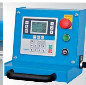
Programmierbare Schnittsteuerung und Datenbank für Schnittprofile und Schnittfolgen (Steuerungsvariante)
