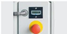
Der Kontakthubzähler zählt fortlaufend die Schnittbewegungen der Tafelschere. Sein Zählwerk mit Reset-Funktion wird manuell eingestellt und vom Bediener auf vielfältige Weise genutzt. Z. B. erfasst der Kontakthubzähler die bereits erledigten Schnitte pro Auftrag oder ermittelt die Schnittbewegungen pro Tag, Woche und Monat für statistische Auswertungen.
