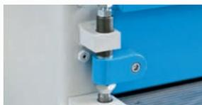
Damit hat der Bediener das Schnittgut ohne manuellen Kraftaufwand auf Knopfdruck fest im Griff. So komfortabel fixiert hält der Niederhalter das Schnittgut sicher auf Position. In Verbindung mit der rutschfesten Hartgummieinlage wird die empfindliche Schnittgutoberfläche auch vor Kratzern geschützt.
