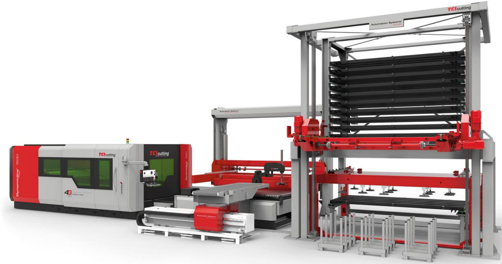
Dynamicline Fiber mit simultaner Be- und Entladung, Lagerung und intelligenter Sortierung.
